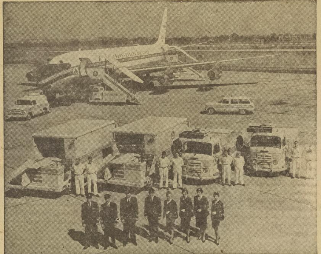
Voici un avion à réaction DC-8 d'Air Canada avec l'équipage aérien, l'équipe au sol et le matériel nécessaires à sa manœuvre. Au premier plan se trouve le personnel navigant qui comprend le commandant, le premier copilote et le second copilote, un steward et quatre hôtesses. Immédiatement derrière, à gauche, on peut voir deux camions à bagages et, à côté, un camion sanitaire et un camion d'eau avec les membres de l'équipe au sol. Juste devant le DC-8 se trouve le compresseur d'air de mise en marche, qui cache en partie le groupe électrogène au sol, tandis que les deux passerelles automobiles sont en place aux portes avant et arrière. La voiture radio du surveillant au sol est au centre. Cette photo représente un avion de $6,000,000, un équipement au sol d'une valeur de $103,000 et de nombreuses années de formation et d'expérience.
