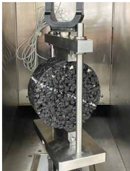
Photo 2 : Montage de l'essai d'IDEAL-CT
