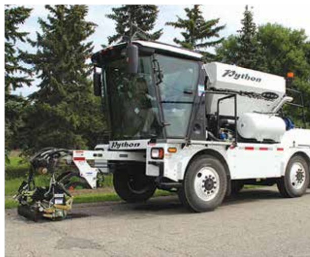
FIGURE 10 VÉHICULE AVEC ÉQUIPEMENT DE POSE AUTOMATISÉ
