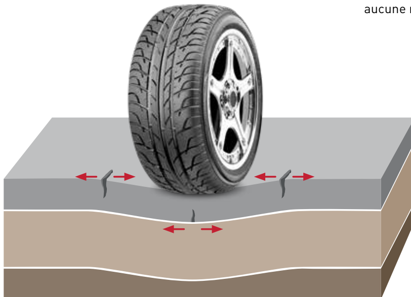
FIGURE 2 EFFET DU TRAFIC ET DE LA FATIGUE SUR LE REVÊTEMENT BITUMINEUX
