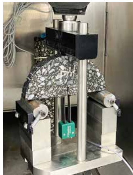
Photo 3 : Montage de l'essai SCB
