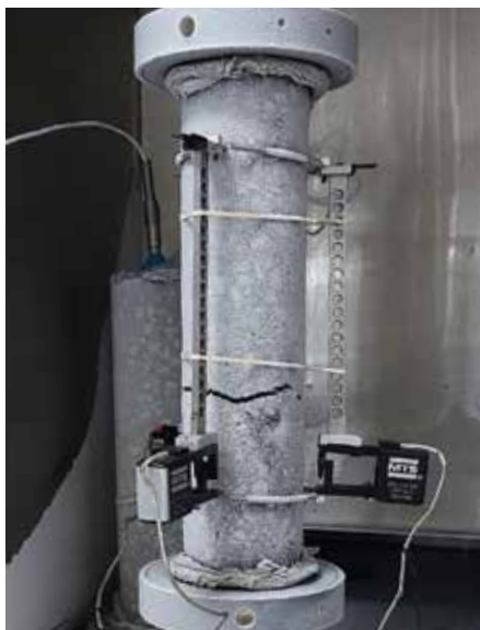
Photo 1 : Montage de l'essai de TSRST
