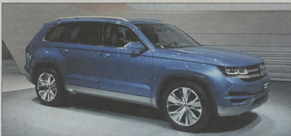
Le Volkswagen Crossblue Concept est un multisegment à sept places d'une longueur de cinq mètres. La motorisation hybride qui peut être branchée est composée d'un moteur diesel (190 ch) et de deux moteurs électriques.
