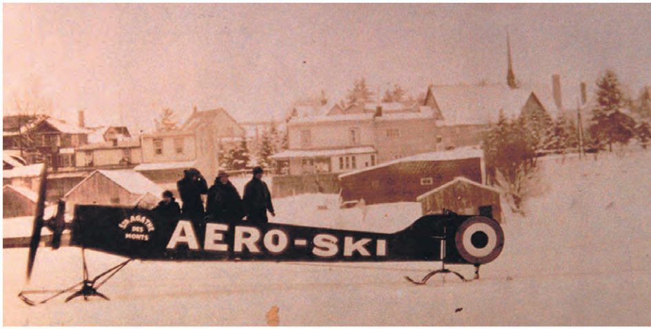
Aéro-ski aux ailes tronquées de Moïse Paquette pour tirer les skieurs sur le lac des Sables en 1937. Le « patenté » de Sainte-Agathe a aussi inventé un remonte-pente à câble pour les skieurs. (Photo Comité du patrimoine de Sainte-Agathe-des-Monts)
