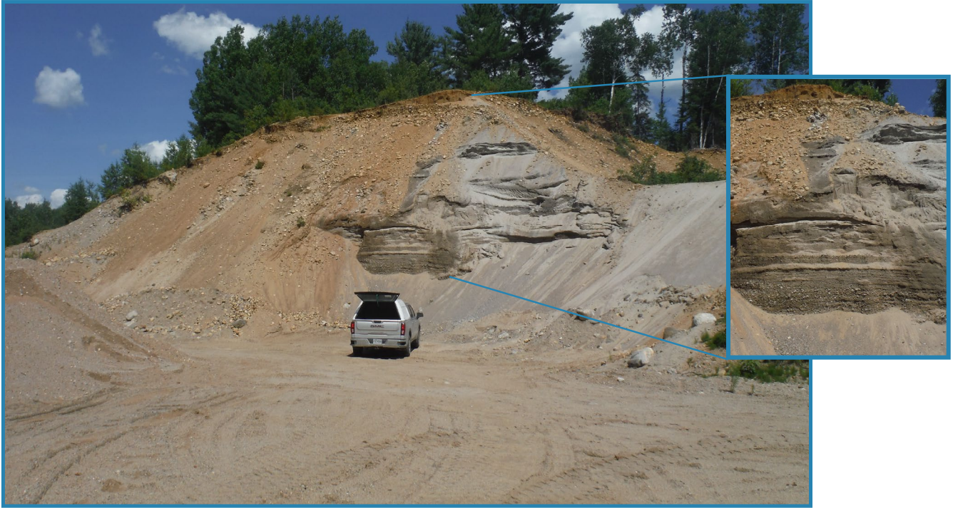
Photo 27 : Face de 6 à 8 m de hauteur composée de galets et de quelques cailloux dans une matrice sableuse reposant sur du sable moyen à grossier stratifié (source 24, site 272, 31J06).
