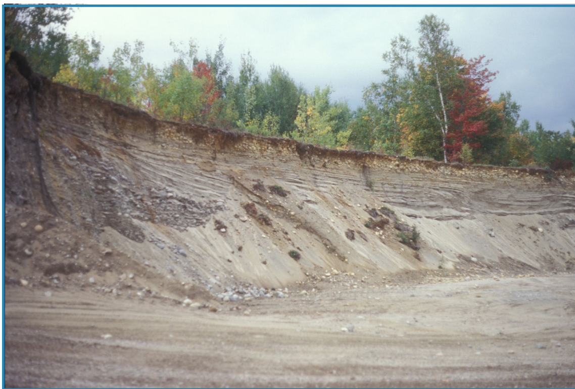
Photo 9 : Face fraîche de 8 à 12 m de hauteur formée de sable moyen à grossier stratifié avec des interstratifications de galets avec quelques cailloux dans une matrice de sable grossier (source 12, site 197 en 1995, 31J12).
