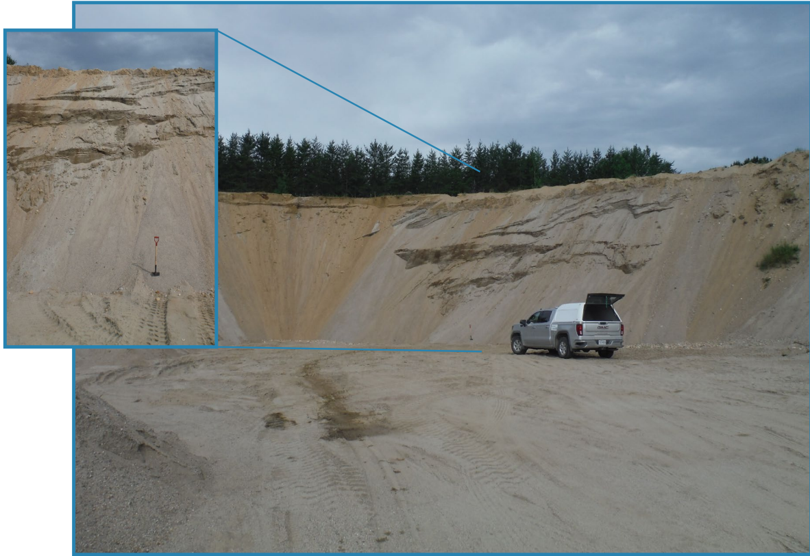
Photo 1 : Face de 8 à 10 m de hauteur constituée de sable moyen stratifié avec quelques lits de gravier surtout concentrés en surface (source 2, site 241, 31K08).
