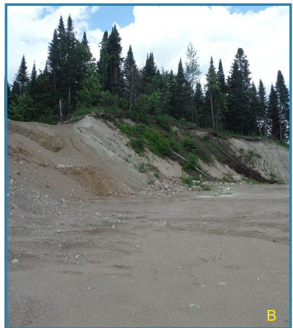
Photo 38 : Faces de 8 à 10 m de hauteur formées principalement de sable fin à moyen stratifié (A) avec quelques zones de galets et cailloux arrondis (B). Présence par endroits de lits de sable fin silteux en surface (source 29, site 108, 31J11).
