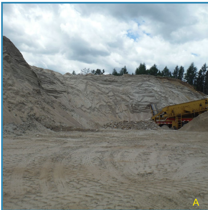
Photo 38 : Faces de 8 à 10 m de hauteur formées principalement de sable fin à moyen stratifié (A) avec quelques zones de galets et cailloux arrondis (B). Présence par endroits de lits de sable fin silteux en surface (source 29, site 108, 31J11).
