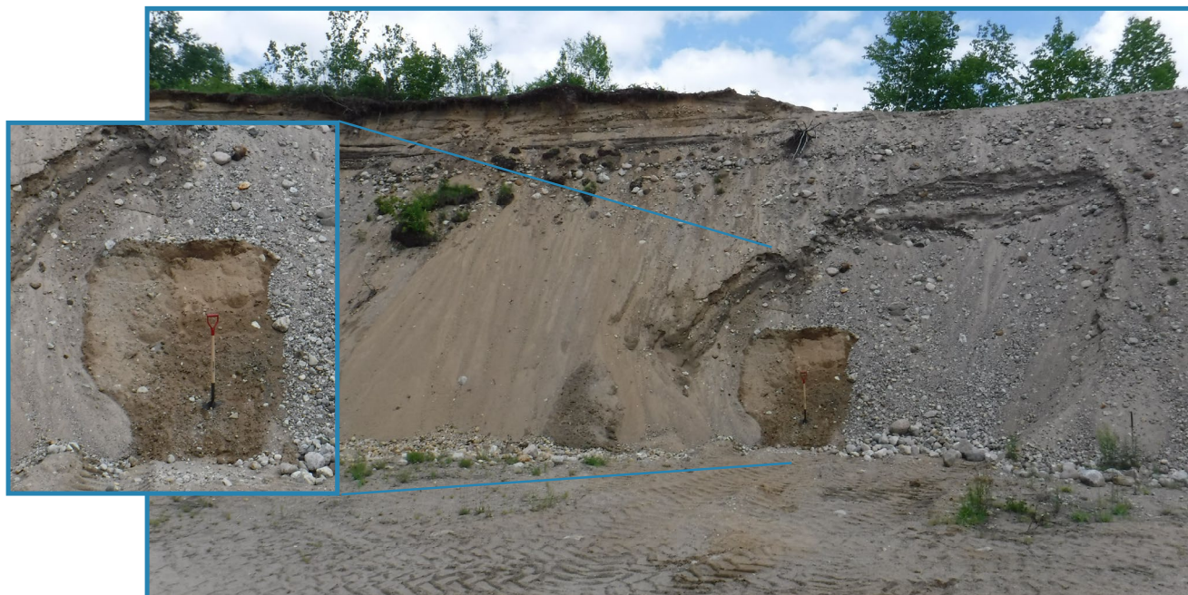
Photo 17 : Face de 8 à 10 m de hauteur composées de sable moyen à grossier stratifié avec des lits métriques de galets et de cailloux arrondis (source 22, site 18, 31J12).
