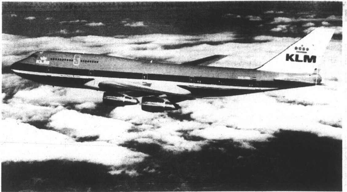
Le nouveau Boeing 747-300 de KLM comporte une cabine supérieure allongée et plus spacieuse.
