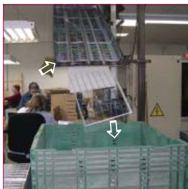
Les retailles tombent directement dans le bac à recyclage par effet de gravité.
