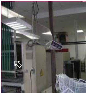
Section des courroies dressées vers le haut qui acheminent les retailles à travers une chute.
