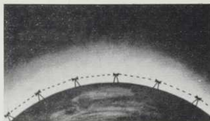
Ce dessin montre la chaîne de transmission des ondes courtes à la surface de la terre au moyen de tours placées à environ trente milles de distance l'une de l'autre.
