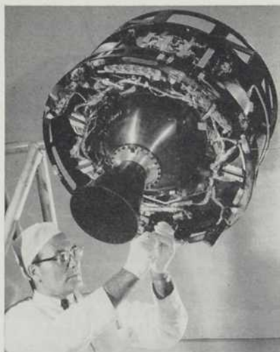
Le premier satellite de télécommunication à haute altitude, le Syncom I. On voit ici un technicien qui fait une dernière vérification avant de fixer les piles solaires sur le pourtour du satellite.
