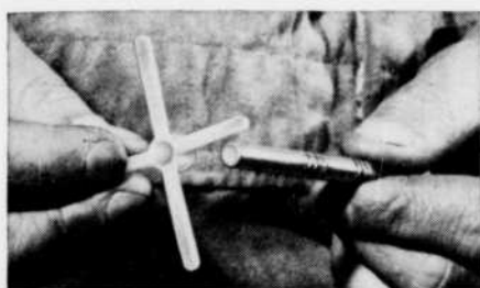
Le nouveau support en plastique est glissé sur l'amorce "Anodet" à retard afin de l'ancrer au centre du trou de mine.
