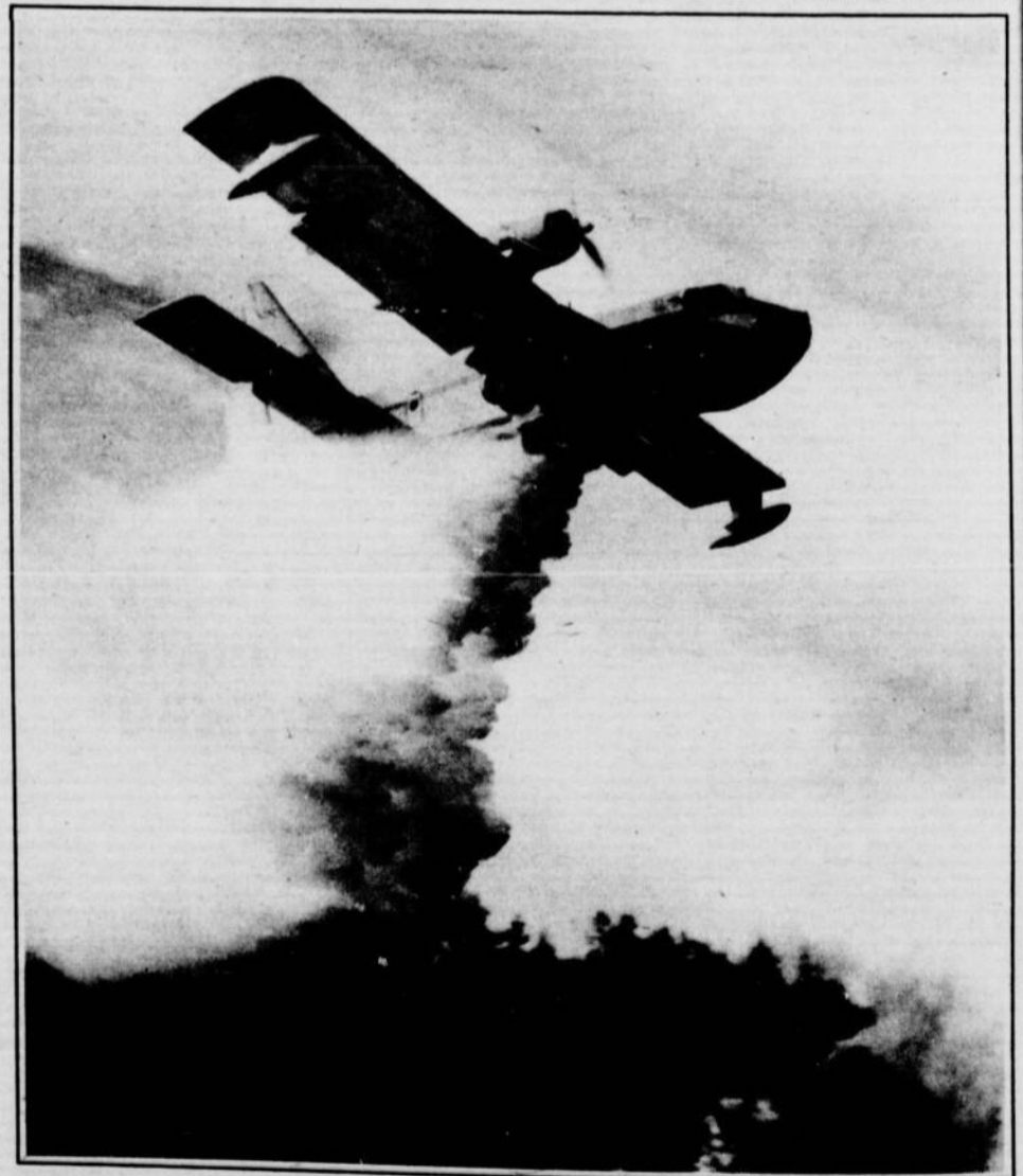
Les CL215 de Canadair effleurent l'eau et en 9 secondes s'approvisionnent de 6 tonnes d'eau qu'ils vont déverser au coeur de l'incendie, à 500 pieds d'altitude. Même si le Québec les fabrique, on répète volontiers que le ministère des Terres et Forêts n'en a pas suffisamment à son service.
