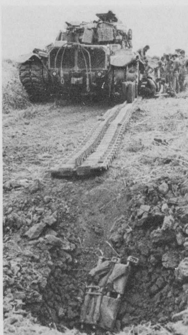
Des "marines" américains évaluent les dommages infligés à leur blindé par l'explosion d'une mine vietcong. L'explosion a arraché une maille de la chenille, près de Dong Ha; l'état de la pièce dans le trou de mine donne une idée du problème que pose une telle "crevasse".
