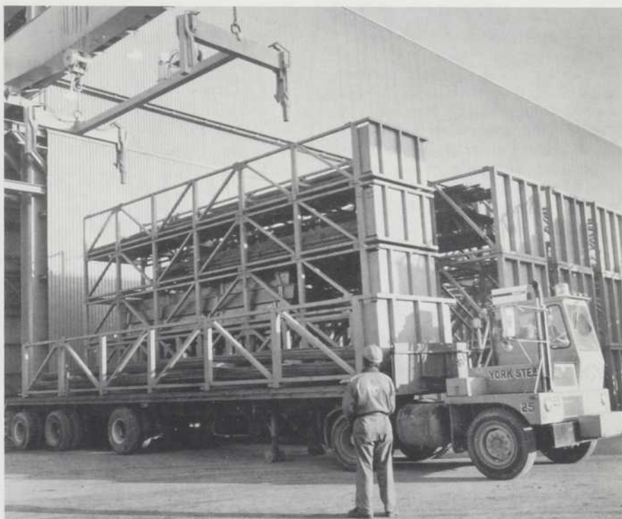
Chez York Steel, à Toronto, un pont roulant muni de grappins à commande hydraulique empile les conteneurs sur des remorques à plateau. Chaque conteneur contient de 20 à 30 tonnes d'acier de charpente. On peut en empiler six.
