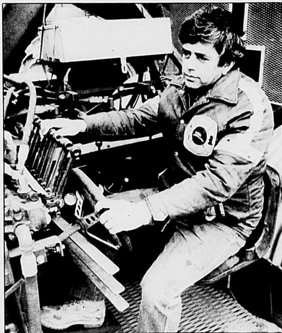
C'est à l'aide de ce petit tracteur muni d'une vis que l'on alimente le convoyeur primaire. En bas, M. Audette au volant de la machinerie, qui est située hors de la cabine du camion, du côté gauche.
