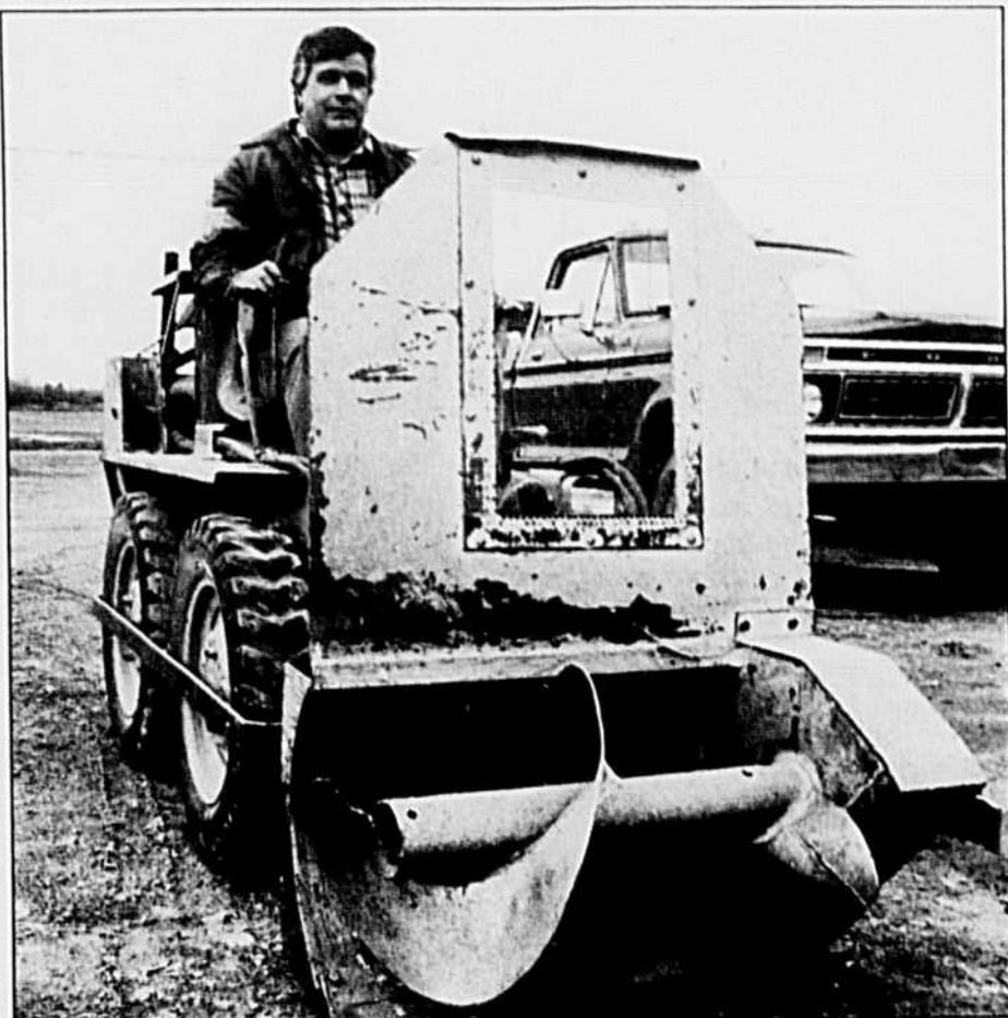
C'est à l'aide de ce petit tracteur muni d'une vis que l'on alimente le convoyeur primaire. En bas, M. Audette au volant de la machinerie, qui est située hors de la cabine du camion, du côté gauche.
