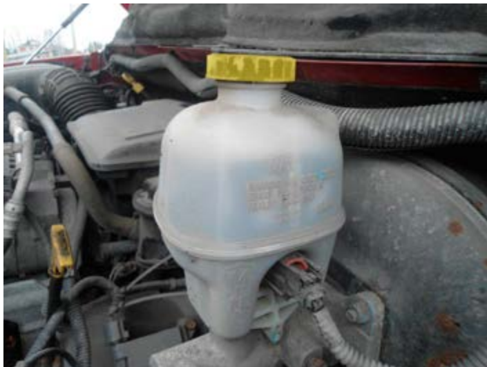
FIGURE 56 | Réservoir du maître-cylindre d'un camion
