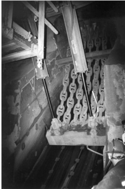
Figure 4.2. Rideau de chaînes de contrôle, méthode d'actionnement directe par cylindre pneumatique ou hydraulique.
