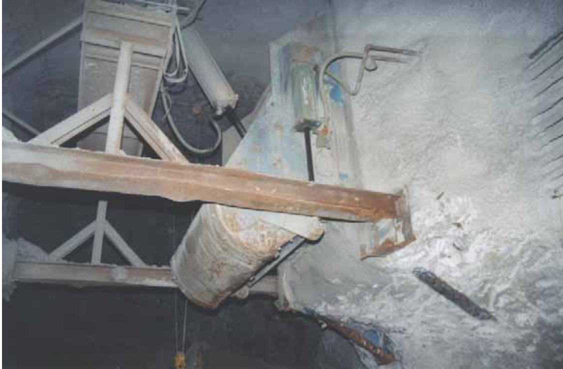
Figure 4.5. Système de rideau de chaînes et de porte pivotante.
