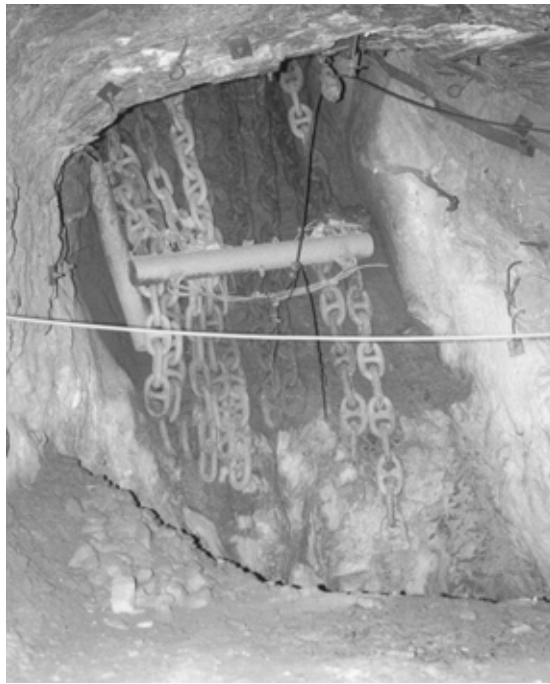
Figure 3.1. Chaînes de contrôle utilisées seules.
