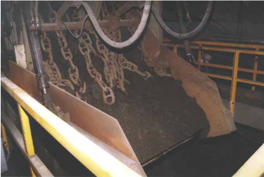
Figure 4.6. Système de lèvre pivotante («lip») et de rideau de chaînes.
