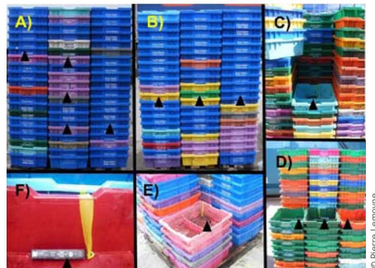
Fig. 4. Six piles de contenants réutilisables dans lesquels des Hobos® (triangles noirs) ont été placés pour prendre la température durant 4 jours (tiré de Vincent et al. 2014).
