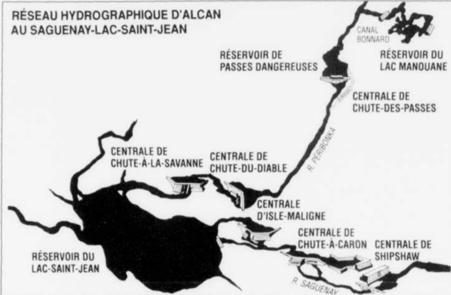
Le bassin hydrographique du Lac Saint-Jean se compose de trois réservoirs dont deux en amont, Manouane et Passes-Dangereuses, et un en aval, le Lac Saint-Jean. C'est en grande partie avec la crue printanière que les réserves d'eau y sont reconstituées.
