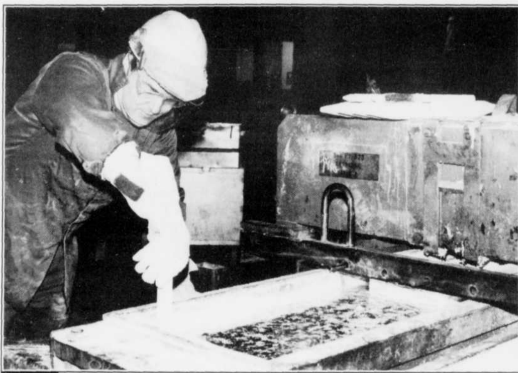
Trop de métal qui coule? Pierre Perron bouche la busette, et le tour est joué.
