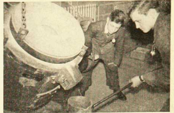
Ci-contre, à l'atelier de modélerie, un élève fabrique un modèle ou pièce de machine qui servira subsequmment dans l'atelier de fonderie. — Ci-dessus, l'élève est à mouler dans le sable le modèle que vient de lui remettre l'atelier de modélerie. Dernière vignette, le métal en fusion est coulé dans le moule.
