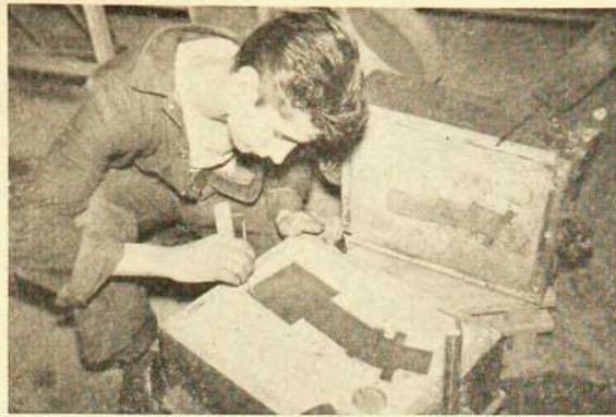
Ci-contre, à l'atelier de modélerie, un élève fabrique un modèle ou pièce de machine qui servira subsequmment dans l'atelier de fonderie. — Ci-dessus, l'élève est à mouler dans le sable le modèle que vient de lui remettre l'atelier de modélerie. Dernière vignette, le métal en fusion est coulé dans le moule.
