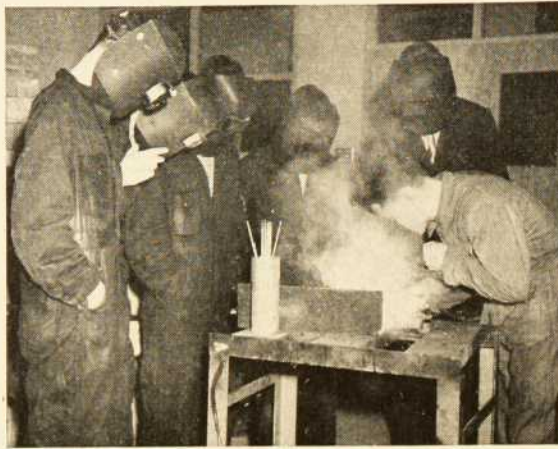
Atelier de soudure de l'Ecole d'Arts et Métiers de Saint-Jean d'Iberville. Démonstration par le professeur Roger Chavanne, devant un groupe d'élèves, d'un exercice de soudure oxyacétylénique.
