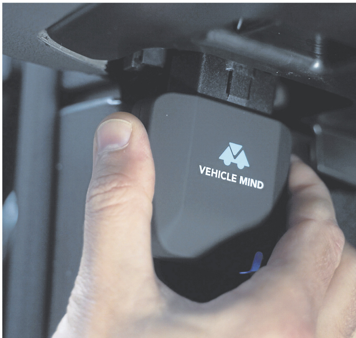
Le système Vehicle Mind se branche dans la prise de diagnostic OBD-II, située dans le panneau de fusible dans la partie basse du tableau de bord. Ce boîtier recueille l'information du véhicule qui est ensuite décodée dans l'application installée dans le téléphone. — PHOTO FOURNIE PAR VEHICLE MIND
