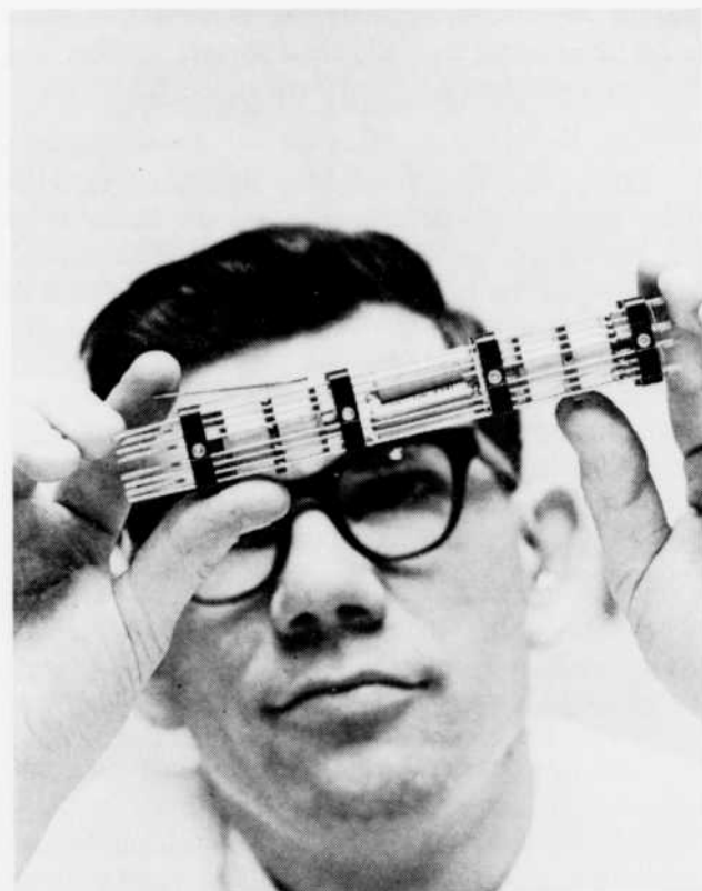
M. Art Moorfield, de Bell Canada, examine un explorateur de ligne. Ce dispositif avertit le contrôle central qu'un récepteur est décroché.
