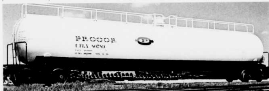
WAGON-CITERNE PROCOR . Destinée au transport de propane et d'ammoniaque, la citerne de ce wagon est en acier au manganèse Algoma et son épaisseur est inférieure de \frac{1}{4} " à celle des citernes couramment utilisées. L'emploi de cet acier réduit le poids de 10% et augmente la résilience de la citerne ainsi que sa capacité.
