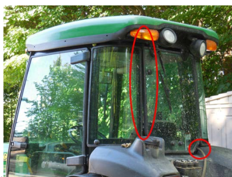
Figure 5 : Cabine de tracteur avec présence d'ouvertures
