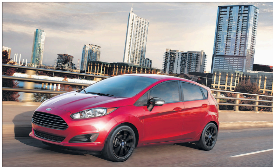
La Ford Fiesta est offerte en modèle à hayon à 5 portes et berline à 4 portes. Le moteur des versions SE est un trois cylindres turbo EcoBoost de 1,0 l et 123 ch.
