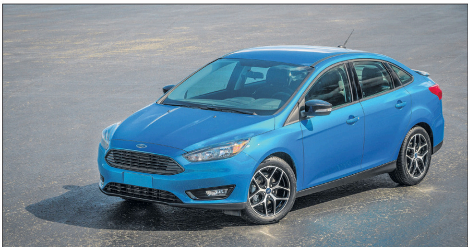
Seule la berline SE de la gamme Ford Focus est animée par un trois cylindres turbo EcoBoost de 1,0 l qui développe 123 ch.
