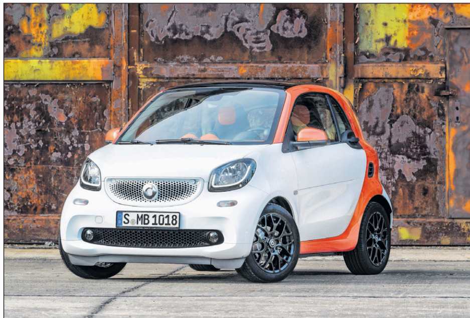
Lors de son introduction en 2008, la Smart était pourvue d'un trois cylindres turbodiesel. La génération actuelle est animée par un trois cylindres à essence de 89 ch.
