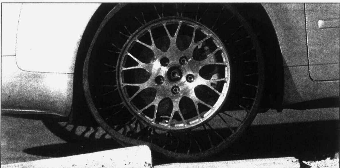
La Tweel est constituée de rayons flexibles reliés à une roue extrêmement souple qui se déforme pour absorber les chocs de la route.
