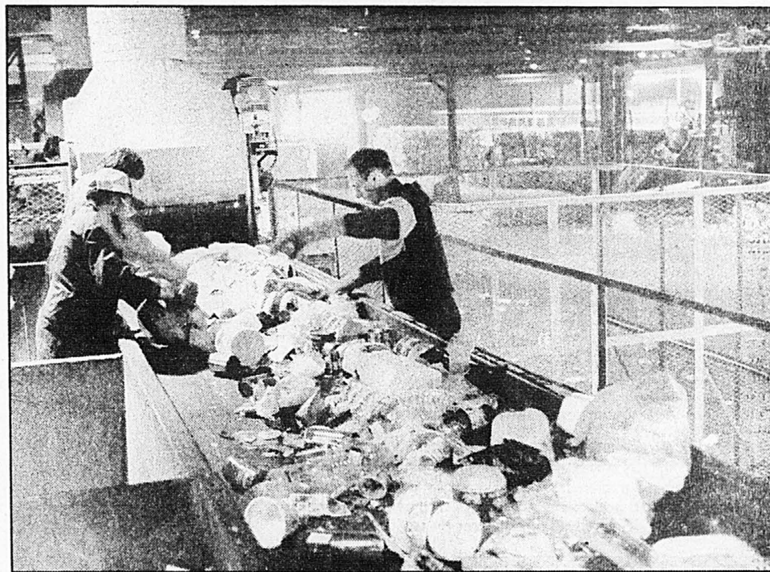
Des employés du centre de tri de Rebutis solides canadiens sont installés de chaque côté d'un tapis roulant et retirent les matières qui ne sont pas recyclables.
