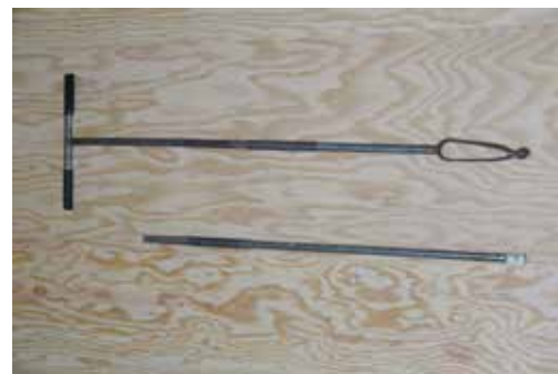
Tarière de pédologue de type « hollandaise Edelman » avec une pointe pour sols loameux et une rallonge baïonnette
