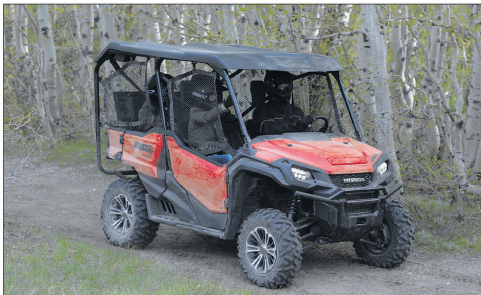
La gamme Pioneer élargit son offre cette année avec l'ajout des modèles 1000 et 1000-5. Le moteur de 999 cm 3 est le plus puissant jamais mis au point par Honda pour un VTT.
