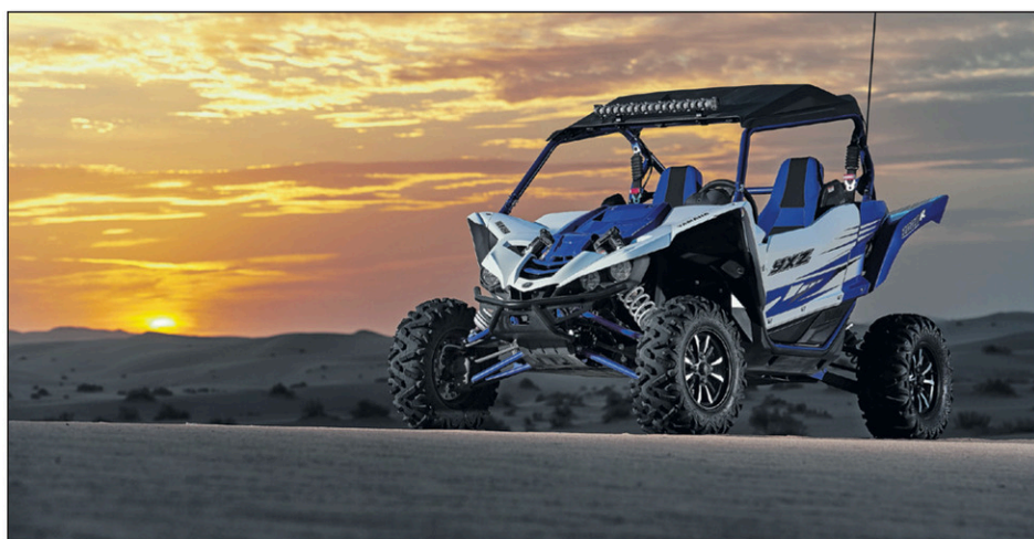
La nouvelle gamme YXZ1000R de Yamaha est animée par un moteur à trois cylindres de 998 cm 3 et 110 chevaux dont la zone rouge débute à 10 500 tr/min.
