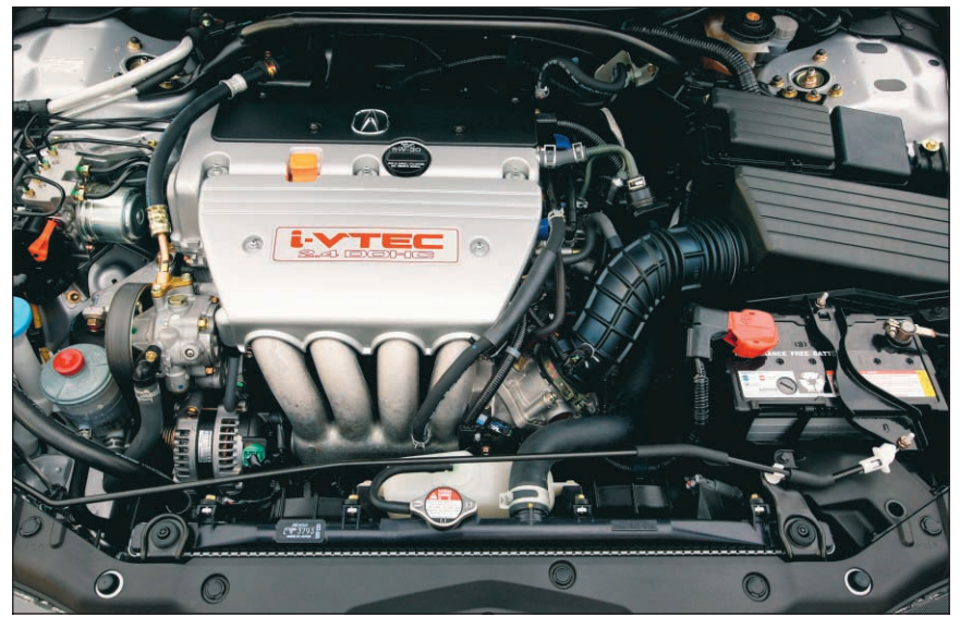
Le capot de la TSX s'ouvre seulement à un moteur quatre cylindres de 2,4 litres. Celui-ci délivre 200 chevaux, soit 40 de plus que celui de l'Accord vendue ici. Il s'alimente cependant en essence super.
