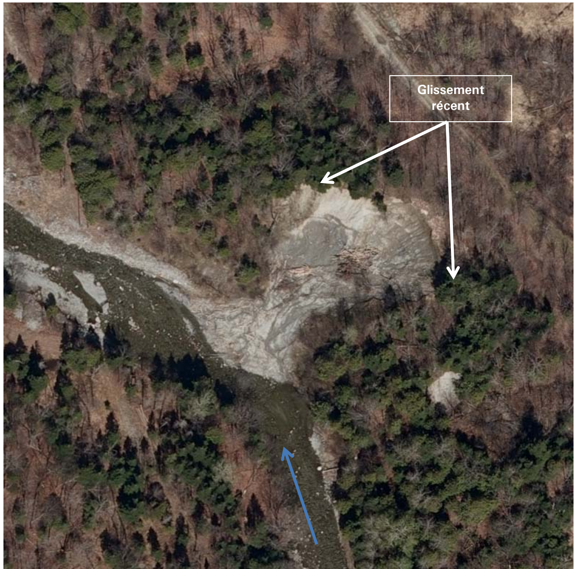
Photo 5 : Glissement de terrain récent sur la rive droite du ruisseau Gobeil (PK 5,6). La flèche bleue indique le sens d'écoulement de l'eau.
