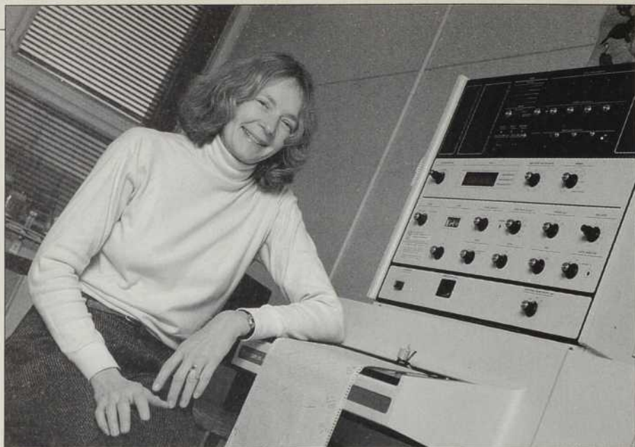
Helga Guderley, biologiste à l'Université Laval, devant un spectrophotomètre. Cet instrument lui permet d'effectuer des dosages d'activités enzymatiques dans les tissus de poissons et de grenouilles.
