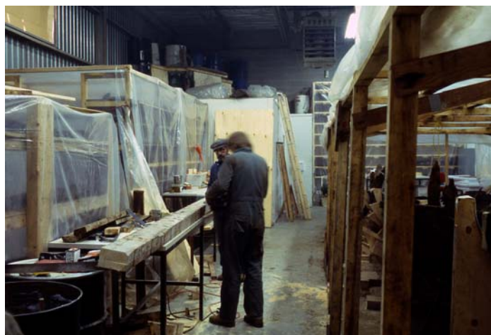
Figure 22 : Une vue de l'atelier de traitement des embarcations. Les éléments démontés des embarcations, placés dans des tentes, subiront un séchage contrôlé et une imprégnation de polyéthylène glycol (PEG) Photographie : CCQ
