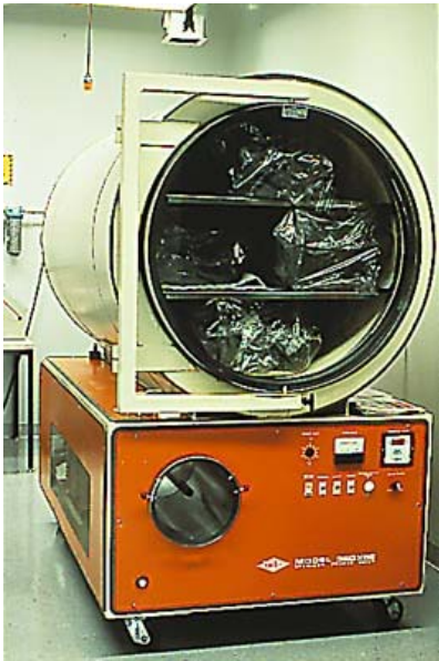
Figure 26 : Un lyophilisateur, un appareil permettant l'extraction de l'eau des objets archéologiques. Les pièces de bois de nos embarcations sont bien trop volumineuses pour un tel appareil... Photographie : Michel Élie, Centre de conservation du Québec
