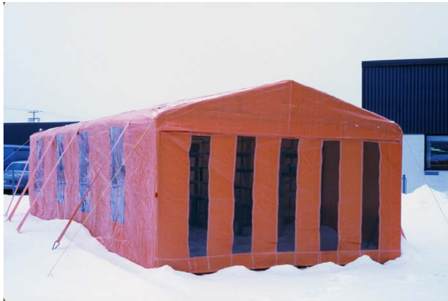
Figure 27 : L'hiver québécois, avec ses températures habituellement sous le point de congélation et un soleil abondant, permet d'effectuer le traitement d'une partie des pièces de bois des embarcations du Musée par une approche appelée « lyophilisation climatique ». Les pièces de bois sont installées dans un garage de toile, orienté selon l'axe des vents dominants, pour favoriser l'extraction de l'air humide. Les portes sont ouvertes tous les jours et des fenêtres orientées vers le sud permettent à la lumière du soleil de réchauffer l'intérieur de l'abri et d'entretenir la sublimation. Photographie : André Bergeron, CCQ
