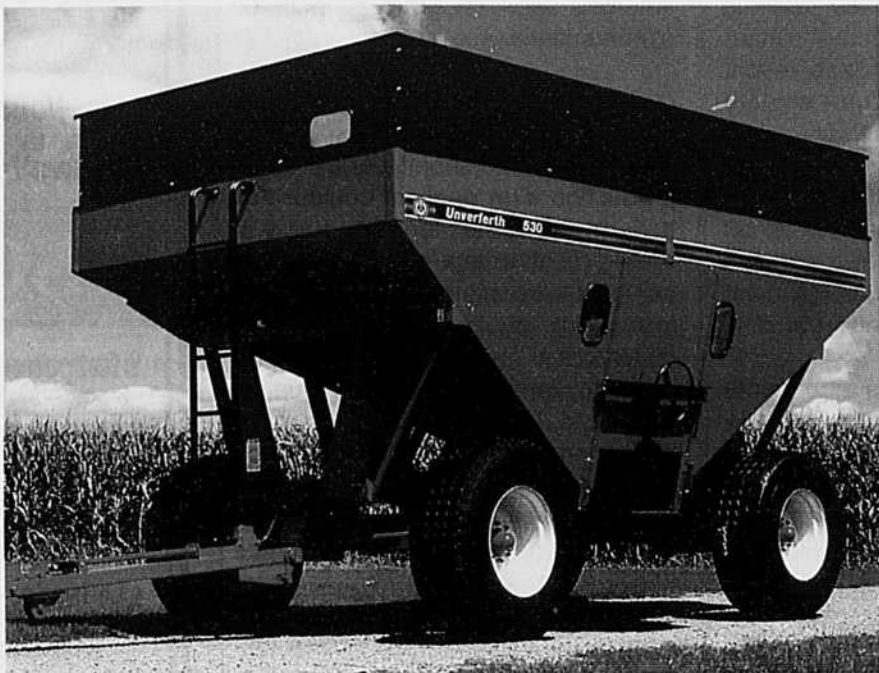
À capacité égale, les boîtes à déchargement par gravité sont généralement moins dispendieuses et impliquent moins de mécanique par rapport à l'autre mode de déchargement
