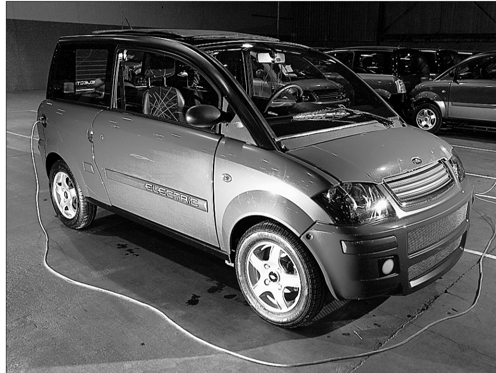
La voiture électrique Zenn, assemblée à Saint-Jérôme, fait évidemment rêver. Propulsée par un moteur électrique à courant alternatif, elle a une autonomie d'environ 60 km et peut atteindre 40 km/h. Il faut cependant huit heures pour obtenir une charge complète de la batterie.
