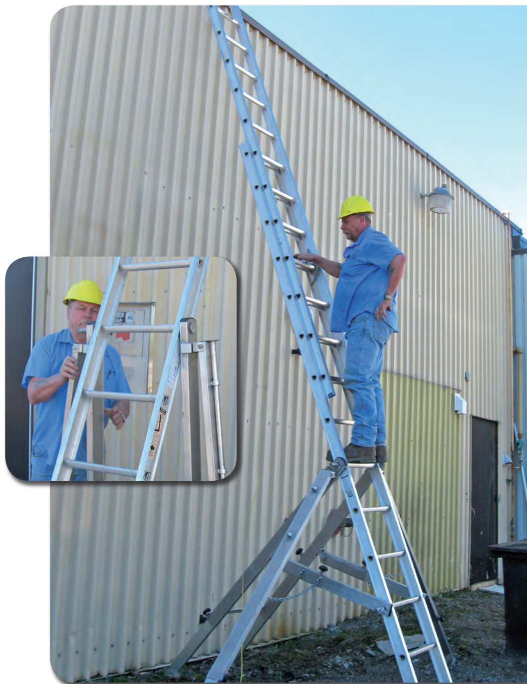
M. Daniel Mc Murray démontrant la facilité d'installation et l'efficacité de son trépied stabilisateur.
