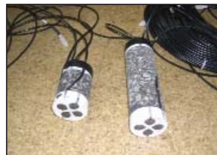
Figure 3 : Jauges de déformation sur carottes d'enrobés bitumineux pour installation dans les revêtements existants
