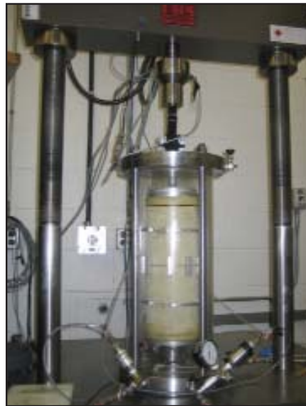
Figure 4 - Montage de l'essai triaxial
