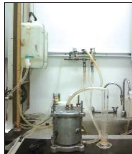
Figure 2 - Montage de l'essai de perméabilité
