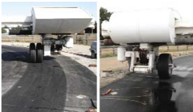
Figure 1: Pneumatiques testés équipant les bras du manège de fatigue de l'IFSTTAR (France)
