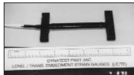
Figure 2 : Jauge de déformation en « H » pour installation à la base de la couche de revêtement (Dynatest)
