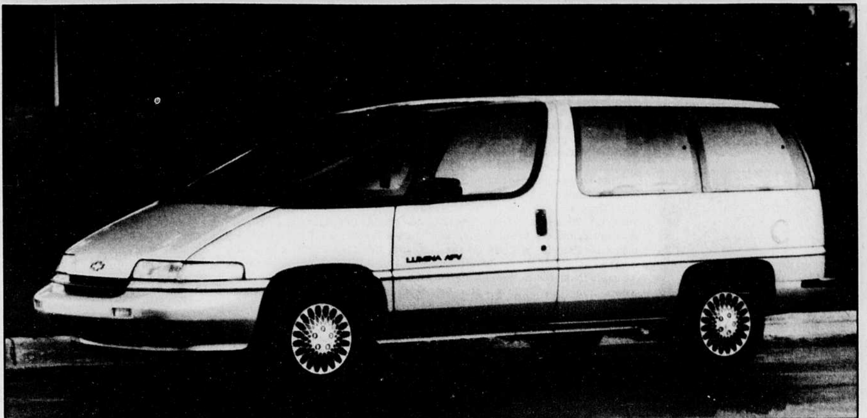
La nouvelle Chevrolet Lumina APV se distingue par son profil très futuriste et une carrosserie réalisée entièrement en matière plastique. La Pontiac Trans Sport partage le même concept.
