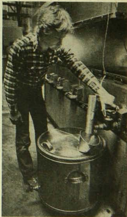
À la fin du cycle, le sirop coule sous contrôle électronique.
