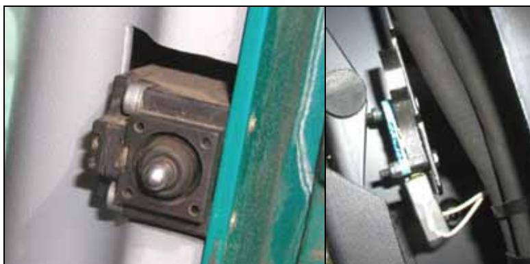
Figure 16 : Abatteuse L - interrupteurs électromécaniques de portière et d'accoudoir
