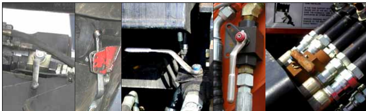
Figure 23 : Échantillon de robinets à tournant sphérique pour la tête
