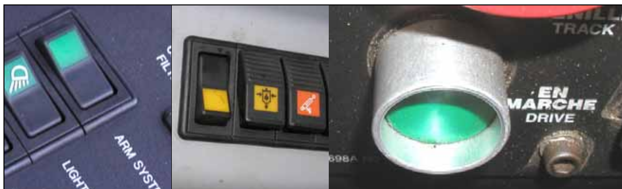
Figure 17 : Boutons à action momentanée pour le réarmement
