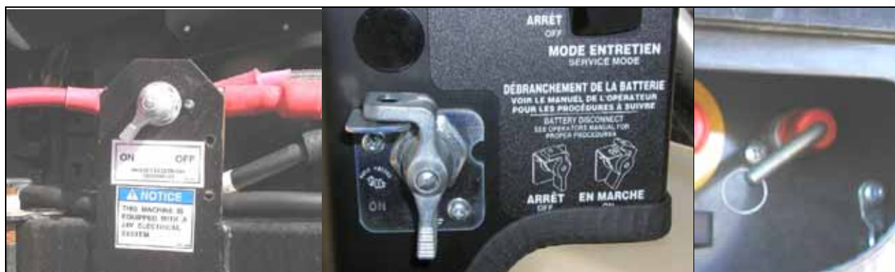
Figure 26 : Coupe-batterie fixe, fixe cadenassable et mobile
