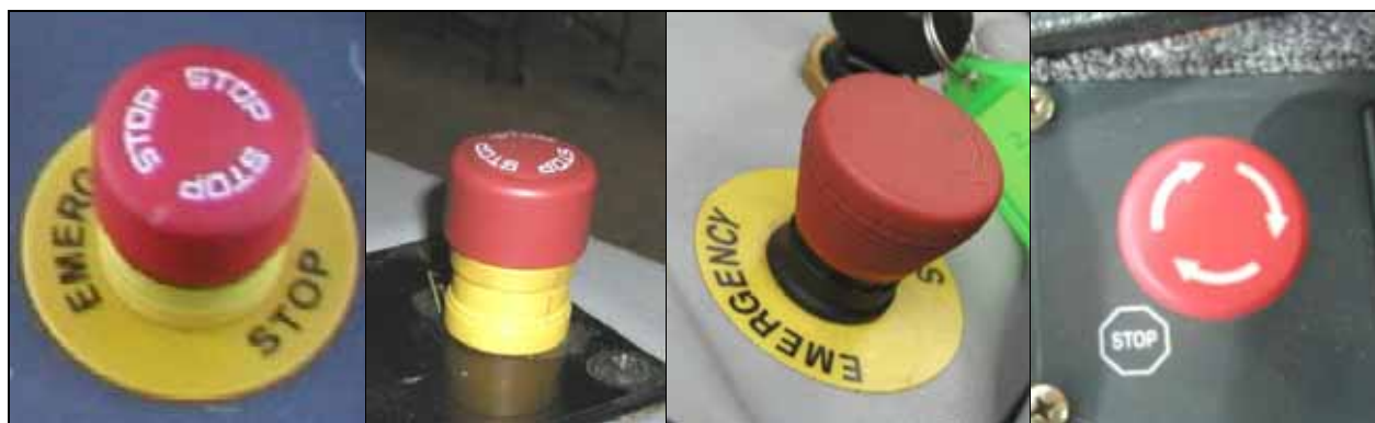
Figure 22 : Échantillon d'arrêts d'urgence recensés sur les abatteuses
