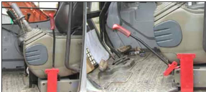
Figure 15 : Levier coupe-pilote hydraulique à action mécanique
