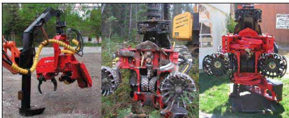
Figure 2 : Exemples de têtes d'abattage multifonctionnelles
