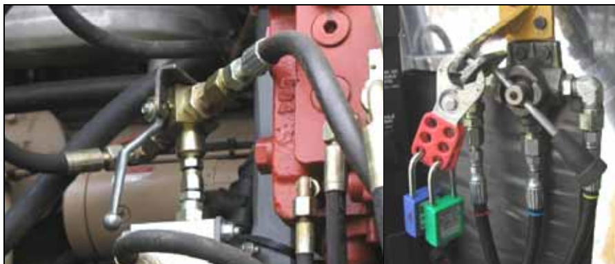
Figure 24 : Autres robinets à tournant sphérique pour le pilote hydraulique
