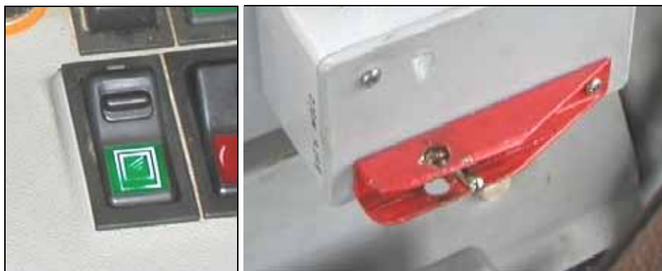
Figure 21 : Boutons d'activation d'ordinateur protégé (gauche) ou cadénassable (droite)
