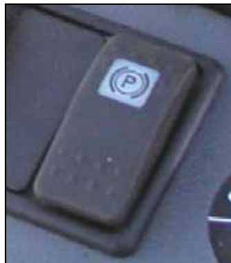
Figure 18 : Frein de parking jouant le rôle d'un réarmement
