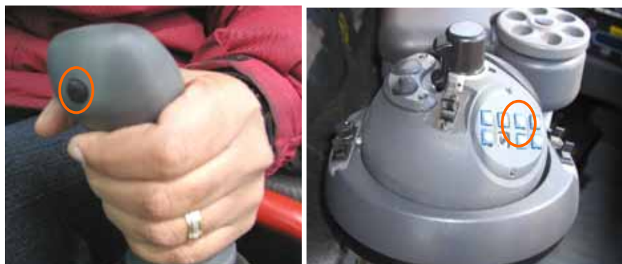
Figure 19 : Boutons à impulsion sur les leviers de commande utilisés lors du réarmement
