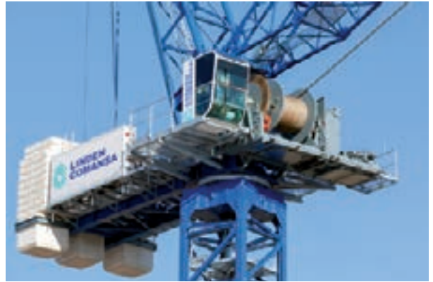
Le moteur de levage de la grue LCL700 permet d'atteindre des vitesses allant jusqu'à 170 m/min.
