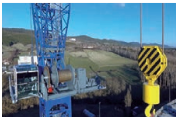
La grue LCL700 dispose d'un tambour de câble de levage à grande capacité, qui permet de construire des bâtiments de plus de 1000 m de hauteur.
