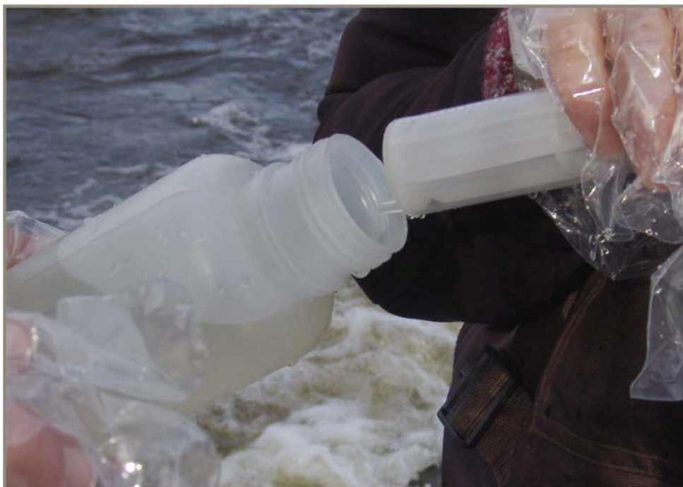
Figure 12 Le préleveur charge la seringue avec 30 ml d'eau de surface.
