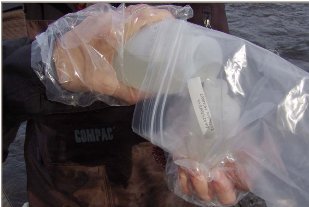
Figure 4 L'assistant transfère l'eau de la bouteille de prélèvement dans la bouteille de conservation à l'intérieur des sacs de protection.
