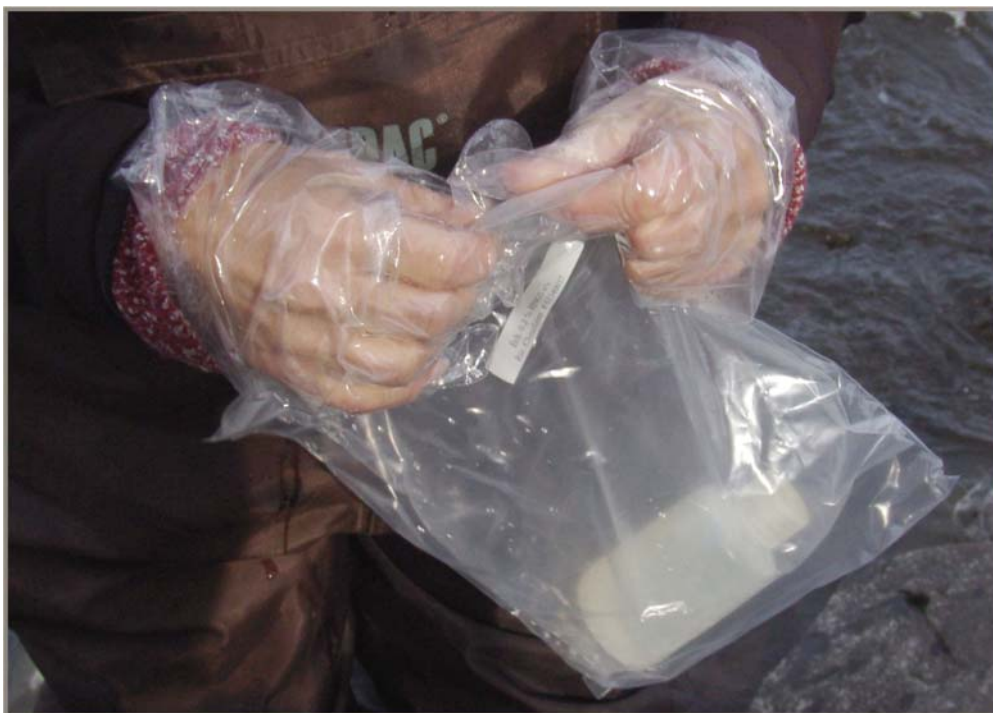
Figure 5 Le préleveur referme rapidement le bouchon de la bouteille de conservation ainsi que les deux sacs.
