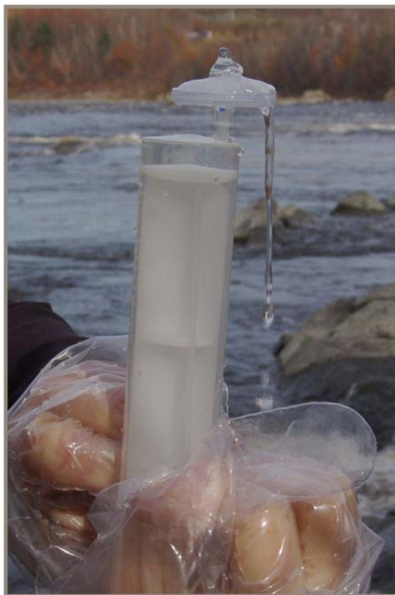
Figure 11 Le préleveur fait passer l'eau ultrapure à travers le filtre.
