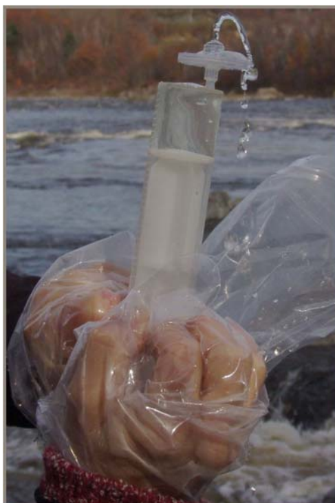
Figure 13 Le préleveur fait passer 5 ml d'eau de surface à travers le filtre pour le conditionner.
