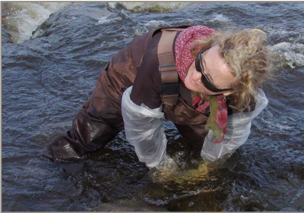
Figure 2 Le préleveur débouche, remplit et referme la bouteille de 500 ml sous l'eau.
