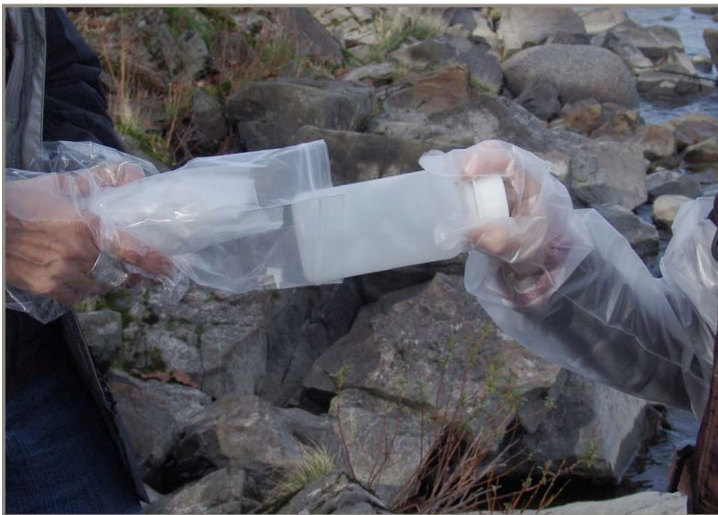
Figure 1 Le préleveur retire la bouteille d'échantillonnage de 500 ml du sac.
