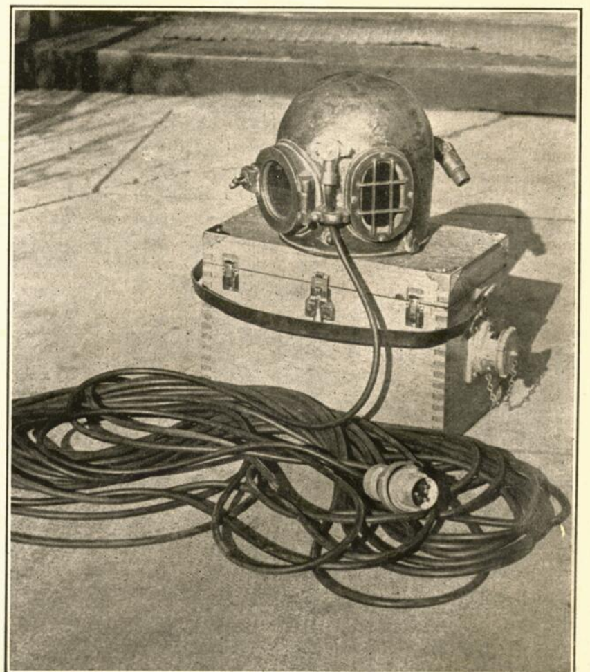
Les grandes compagnies de chemin de fer emploient en permanence des scaphandriers pour contrôler le bon état des piliers de leurs ponts ? On voit ici un scaphandre perfectionné par les ingénieurs du Canadien National et qui, grâce à l'électricité, permet au scaphandrier quand il est sous l'eau, de parler avec les ingénieurs demeurés à l'air libre et d'en recevoir les ordres.
