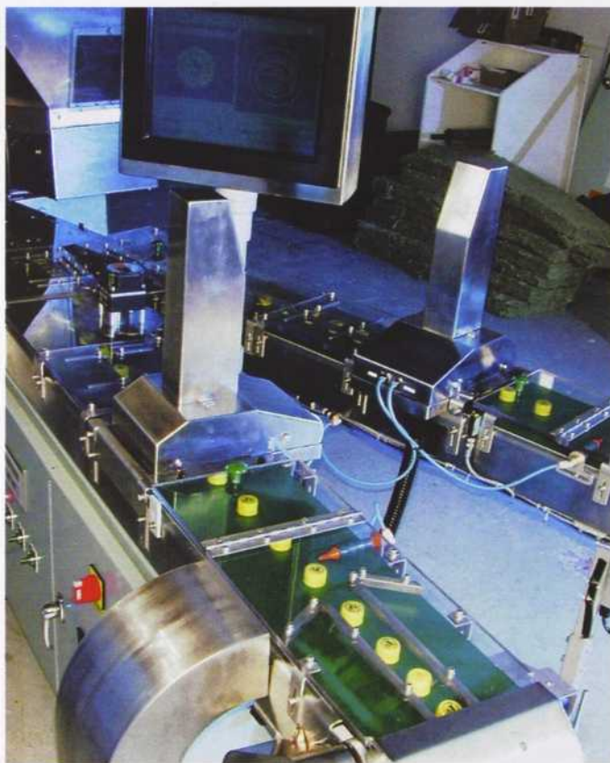
Station d'inspection des bouchons sur deux lignes de production avec une seule caméra par ligne. On peut y analyser jusqu'à 3 500 bouchons à la minute.
