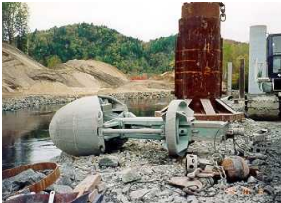
9. Clapet pour excaver l'intérieur d'un pieu caisson
