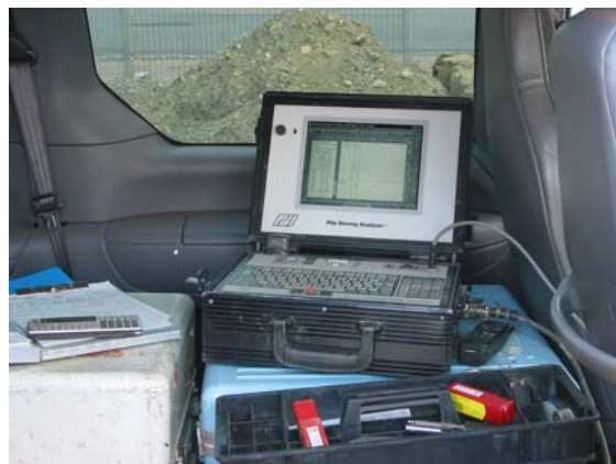
18. Essai dynamique : analyseur de battage
