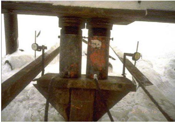
21. Essai de chargement : manomètres, vérins et extensomètres
