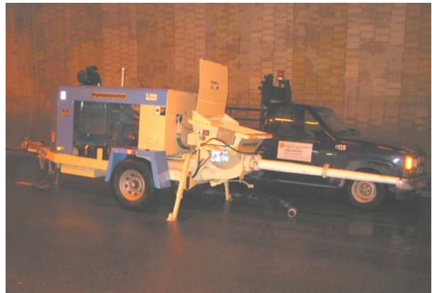
20. Pompe à béton remorquée
