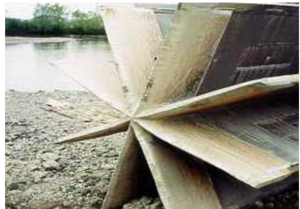
10. Trépan pour la réalisation de l'emboîture
