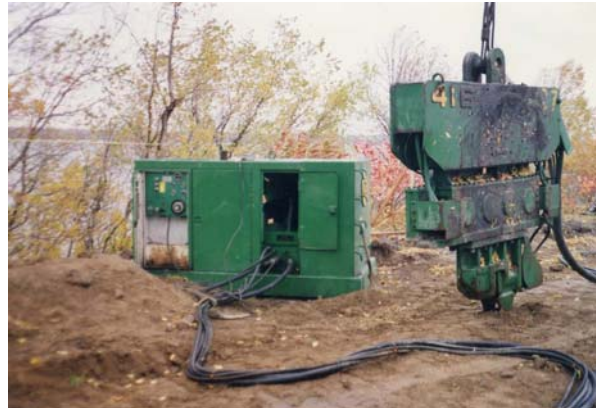
10. Vibrofonceur utilisé pour le fonçage des palplanches métalliques
