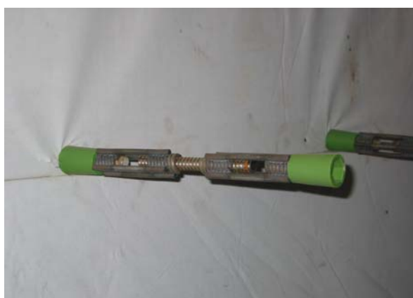
4. Attache de coffrage type « attache avec boudins »
