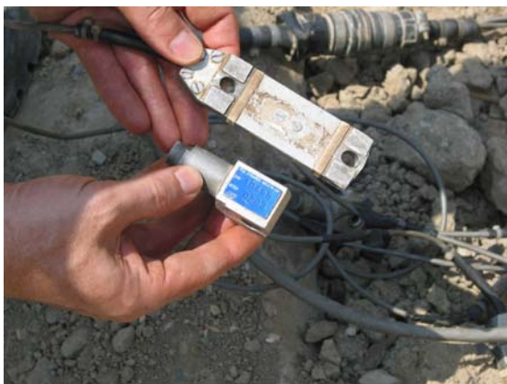
17. Essai dynamique : jauge de déformation et accéléromètre
