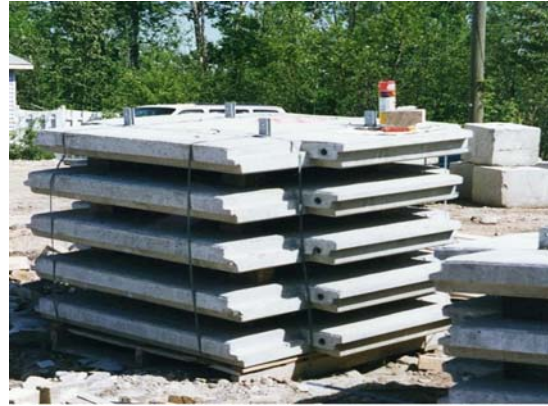
2. Éléments de paroi : regroupés et attachés pour le transport et le stockage
