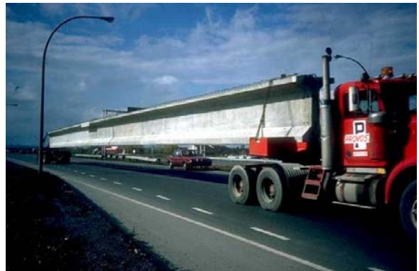
10. Transport d'une poutre préfabriquée
