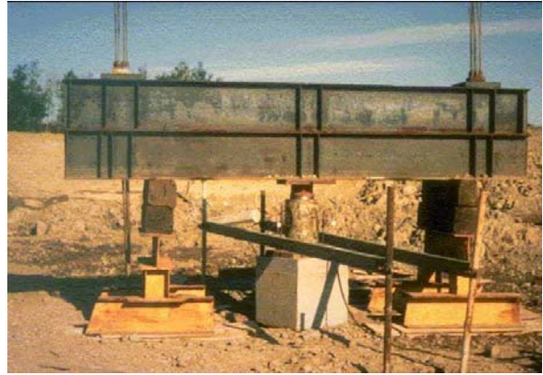
20. Essai de chargement : banc ancré à l'aide de tiges d'ancrages au roc
