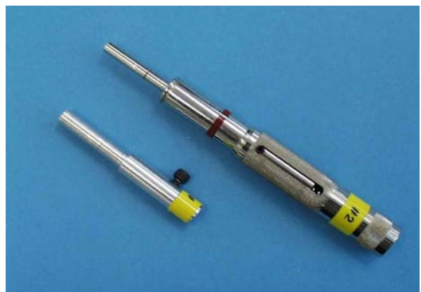
6. Pénétrromètre à aiguille
