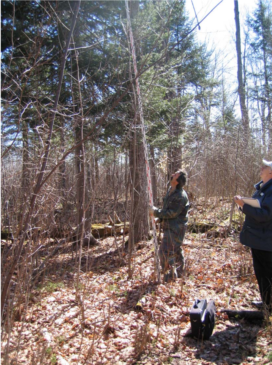
Figure 3. Mesure de la croissance des tiges d'une hauteur comprise entre 2,25 m et 5,00 m à l'aide d'une règle télescopique.
