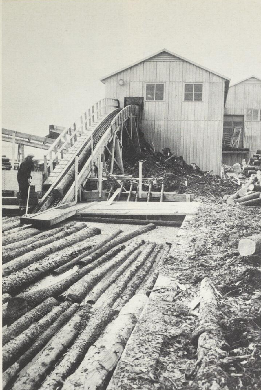
Un homme, armé d'une gaffe, dirige les billots un à un vers le convoyeur qui les entraîne vers l'ancre de l'usine.
