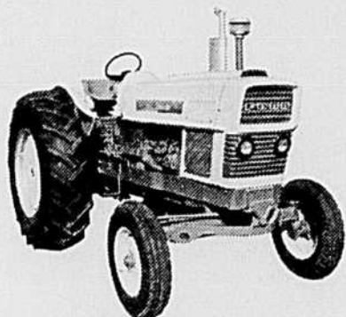
LE FORD COMMANDER 6000. Le tracteur 5 socs le plus perfectionné du monde, dans une version encore améliorée. Moteur de 78 CV*, diesel ou à essence. Servo-direction, servo-freins et changement de vitesses assisté permettant d'effectuer toutes les manœuvres sans fatigue. Transmission, pont arrière et prise de force plus robustes.
