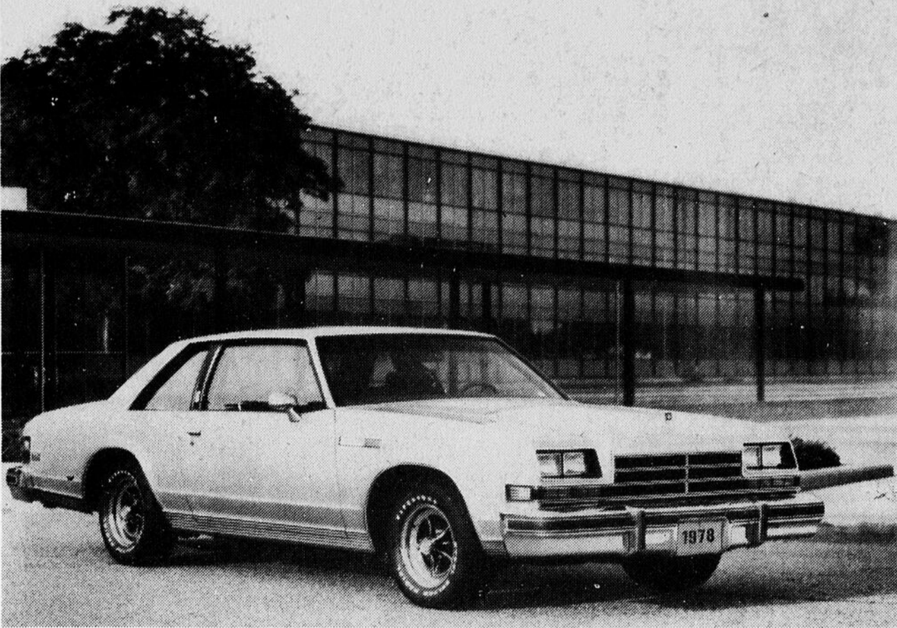
LE COUPE BUICK LESABRE SPORT Le coupé LeSabre Sport de Buick comprend comme équipement de base pour 1978 un moteur V6 de 3.8 litres (231 po. cu.) à carburateur 2 corps avec turbo-compresseur entraîné par les gaz d'échappement. Une autre version du même moteur, avec carburateur quatre corps, est livrable moyennant supplément. Tous les coupés LeSabre Sport sont équipés de barres stabilisatrices et de ressorts
