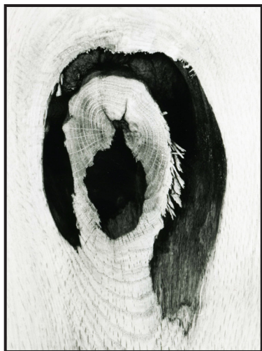
◀ Figure 13 Découpe de la bosse On a trouvé ce gros nœud partiellement pourri à 5,2 cm du sommet de la bosse illustrée à la fig. 12.
