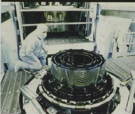
Chandra sera le plus grand satellite jamais transporté. Il est constitué de 4 surfaces réfléchissantes en forme de cylindre emboîtées les unes dans les autres.
