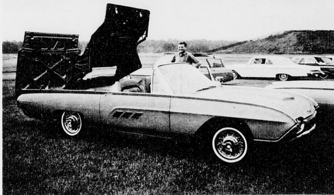
La Thunderbird frappe l'amateur de voitures sport luxueuses par la façon commode dont son toit se replie et se dissimule dans le coffre à bagages.
