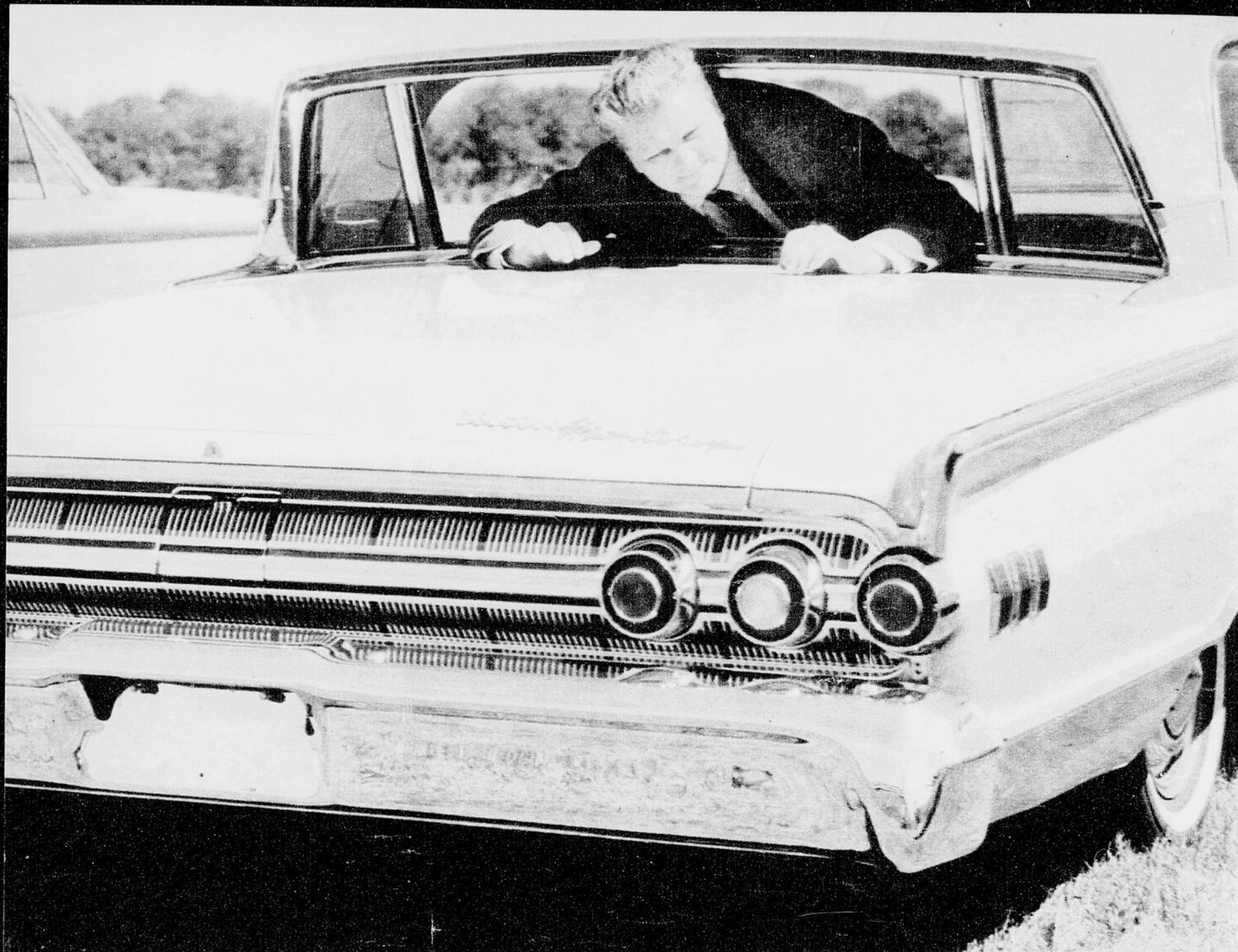
La glace arrière de la Monterey est inclinée parallèlement au pare-brise et sa partie centrale peut s'abaisser, sur commande à distance.
