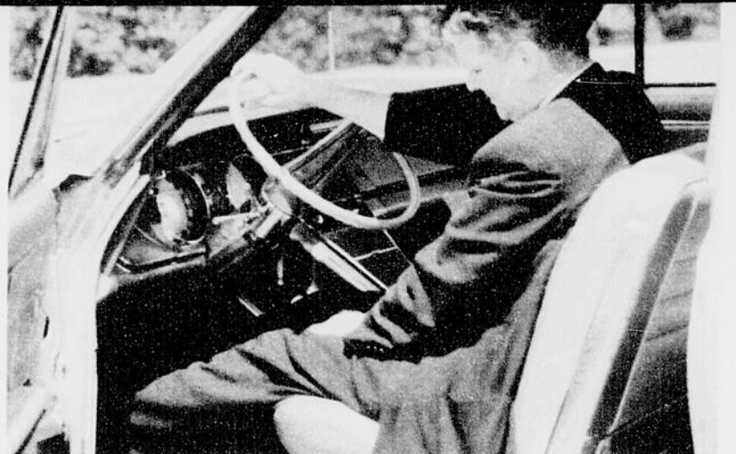
L'auteur place le volant à inclinaison variable et à verrouillage automatique de la nouvelle Buick dans l'une de ses sept positions facultatives.
