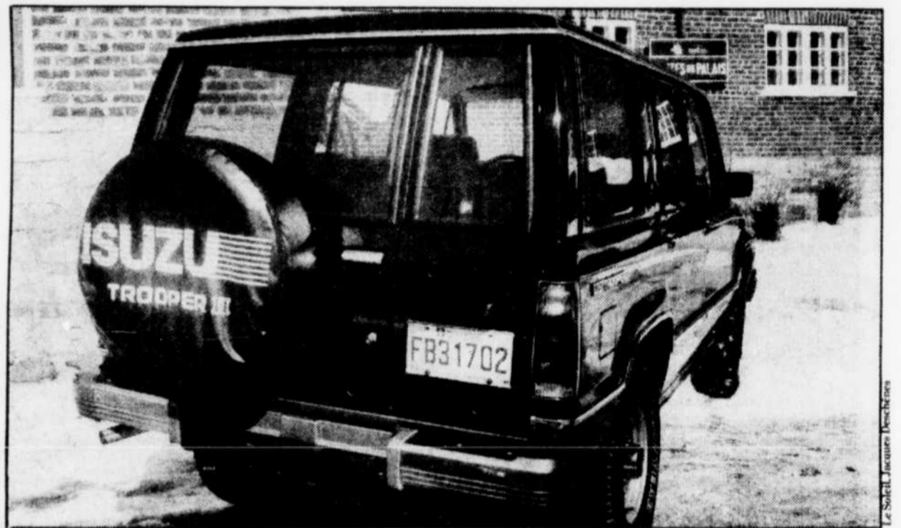
L'arrière s'ouvre en deux parties et la principale portière qui porte le pneu de secours est maintenue ouverte à l'aide d'un dispositif de blocage.
